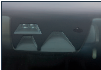
▶ Diferentes sensores, tras el espejo retrovisor, empleados para los sistemas de seguridad activa
