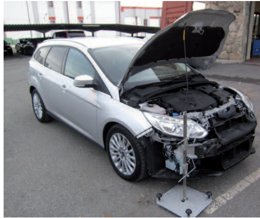
Medición de la altura de la travesía delantera
