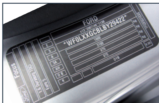
Localización del número VIN, en la placa del fabricante
