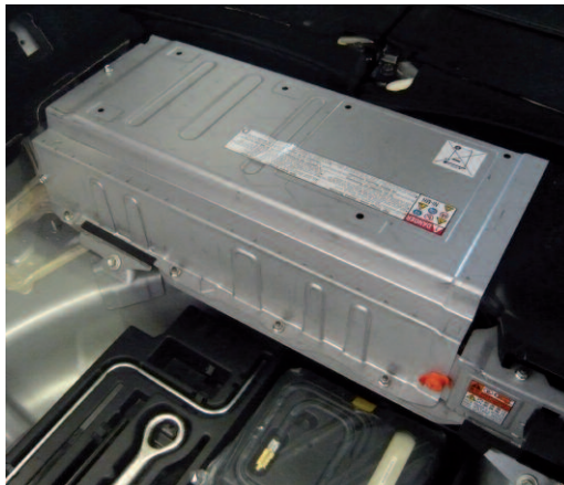
La batería se dispone en la parte trasera, entre ambos ejes
