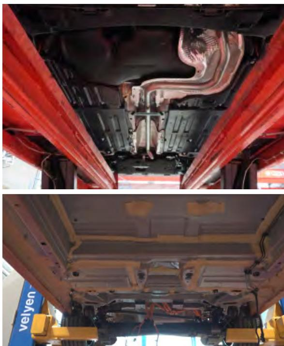
Bajos del Opel Corsa térmico versus Corsa-e
