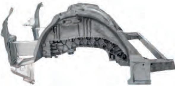
Tesla Model Y: estructura trasera de fijación de la suspensión
