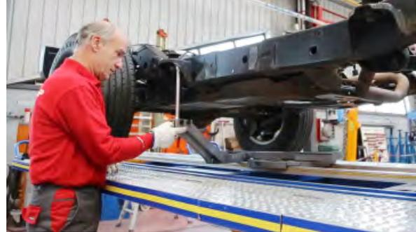
Verificación con medidor electrónico
