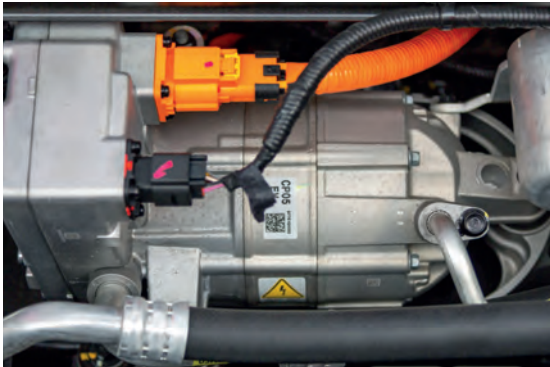
Compresor eléctrico de alta tensión
