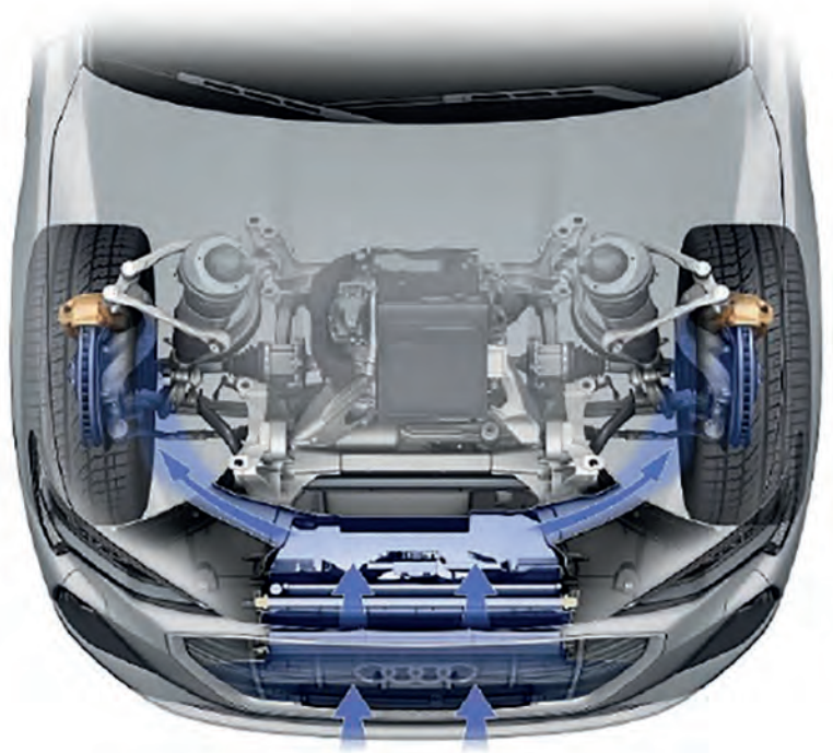
Refrigeración de los frenos delanteros en el Audi e-tron Sportback 55 quattro
