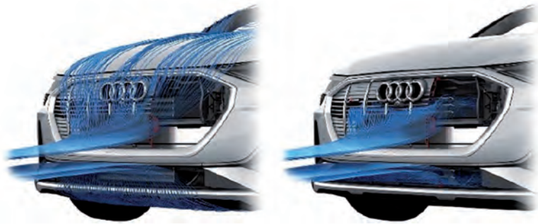
Optimización de la entrada de aire en el Audi e-tron Sportback 55 quattro
