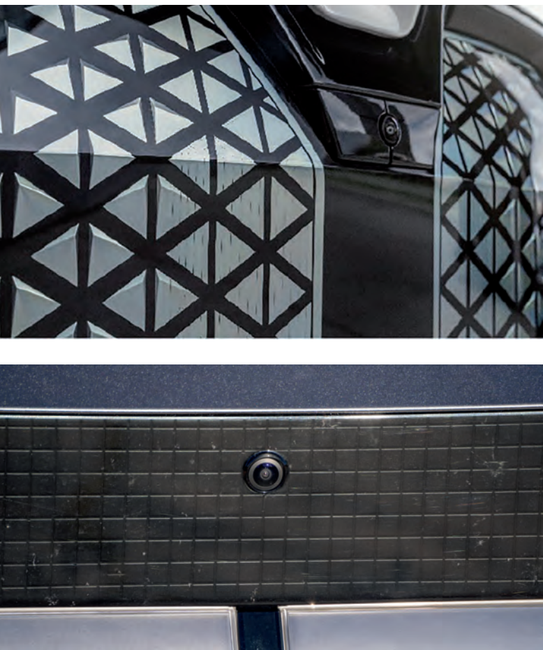
Cámara delantera de visión 360° del BMW IX, arriba, y del Hyundai Ioniq 5
