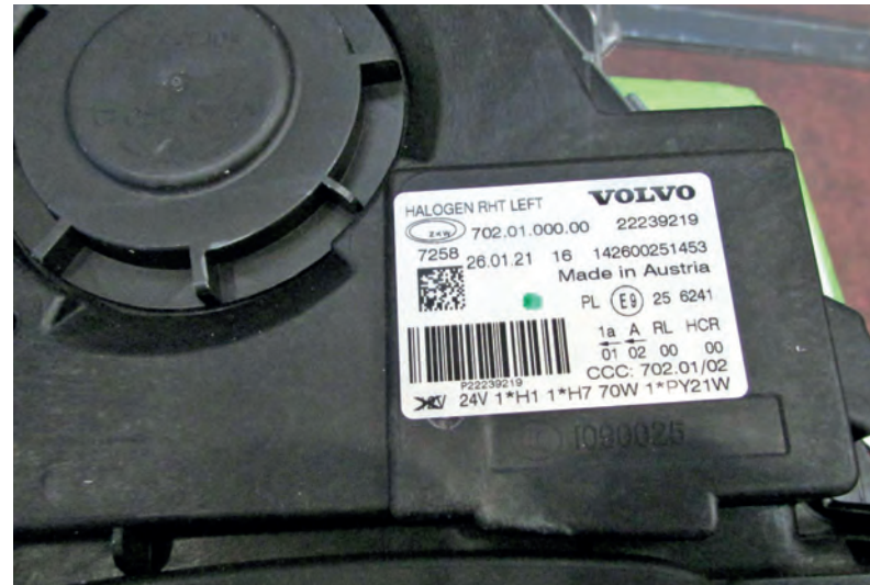
Faro en el que aparece el nombre del fabricante del vehículo, no el del fabricante del faro
