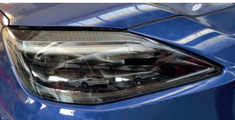
Identificación del tipo de faros (faros LED)
