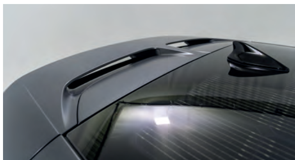
Canalizaciones de aire en el alerón trasero
