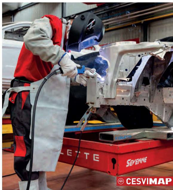
Soldadura con equipo MIG/MAG
