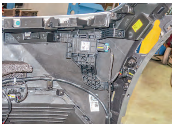
Soporte y radar delantero lateral del Hyundai IONIQ 5
