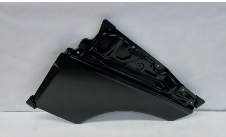
Prolongación de la puerta del Volvo FH
