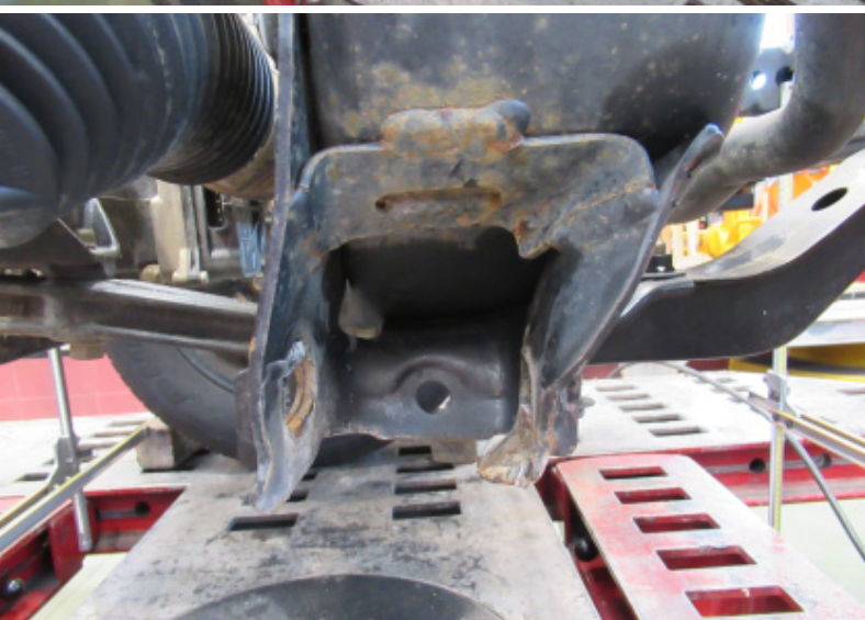
Daños en soporte de triángulo de suspensión
