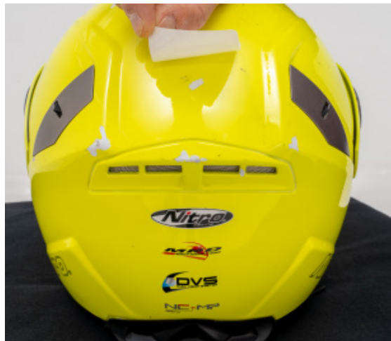
Adhesivo que tapa un daño
