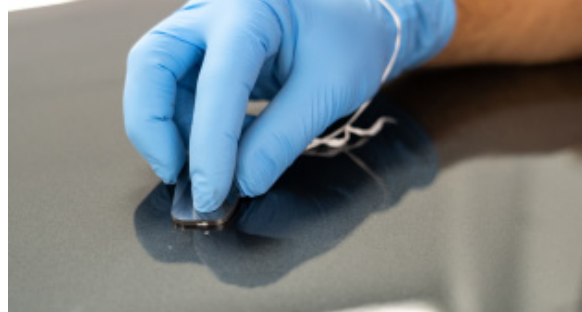
Eliminación de mota mediante cuchilla
