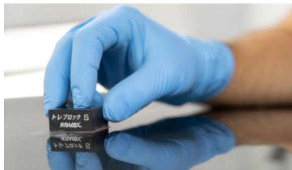
Eliminación de mota con taco microabrasivo
