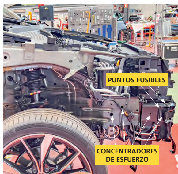
Puntos fusibles y concentradores de esfuerzos en los largueros delanteros.
