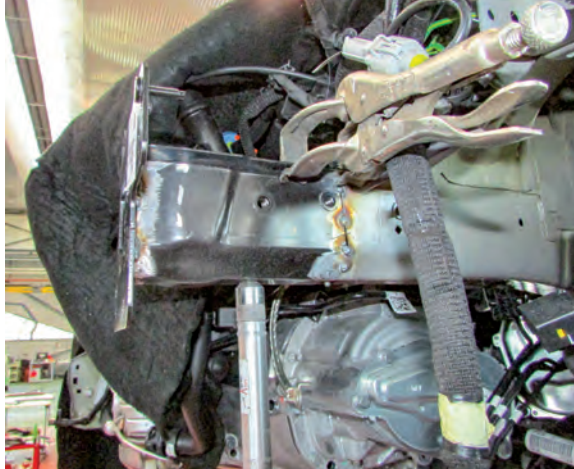
Sustitución de la punta del larguero
