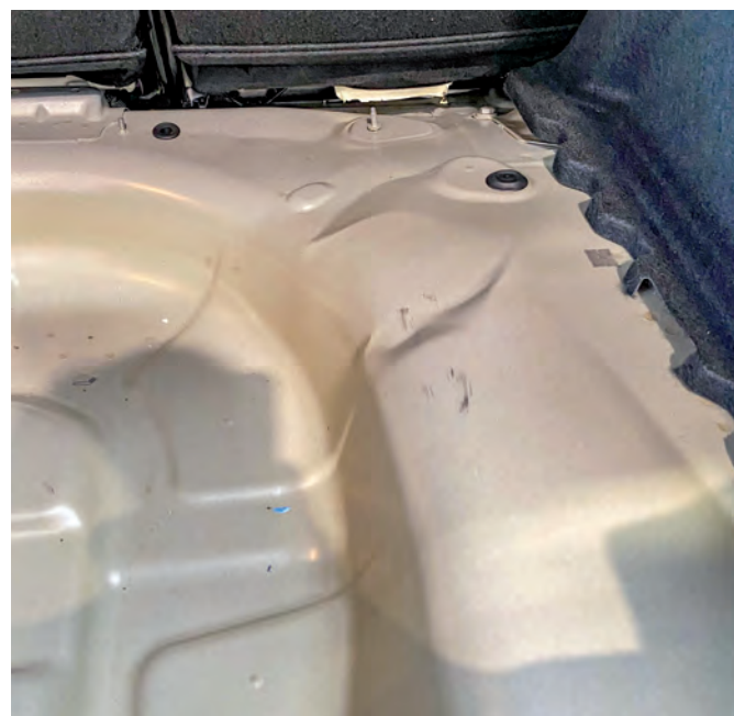
Deformación del piso de maletero
