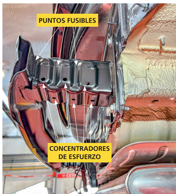
Elementos de un absorbente de travesía trasera
